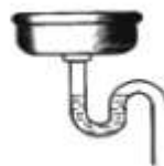
D. 下水道存水管
